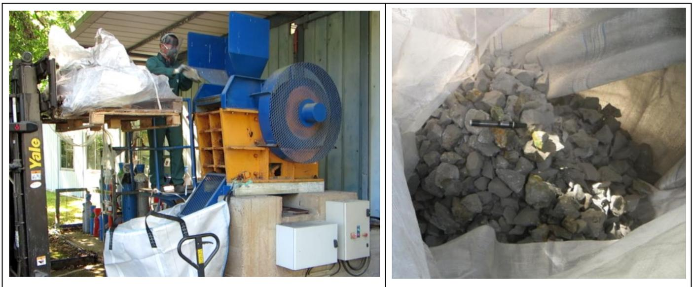
**FIGURE 6 - [LEFT] CRUSHING OPERATION OF THE BOR RUN OF MINE ORE; [RIGHT] BOR RUN OF MINE CRUSHED.**
