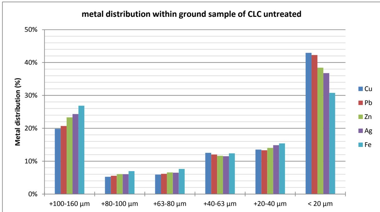
FIGURE 81 – METAL DISTRIBUTIONS BY SIZE FRACTION WITHIN GROUND SAMPLE OF CLC UNTREATED.
