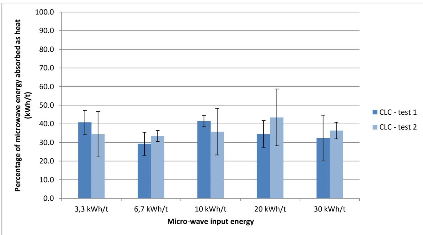
FIGURE 15 - PERCENTAGE OF ENERGY ABSORBED AS HEAT REGARDING THE MICROWAVE TREATMENT OF CLC SAMPLES.
