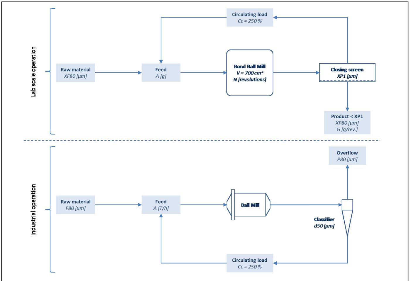
FIGURE 12 - MILLING CIRCUIT: LABORATORY SCALE OPERATION USED FOR BOND METHODOLOGY VS TYPICAL INDUSTRIAL CIRCUIT.
