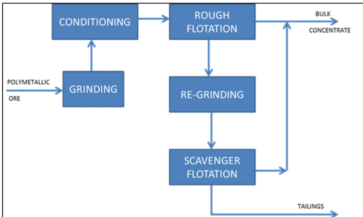
FIGURE 98 - PILOT PLANT BLOCK DIAGRAM.
