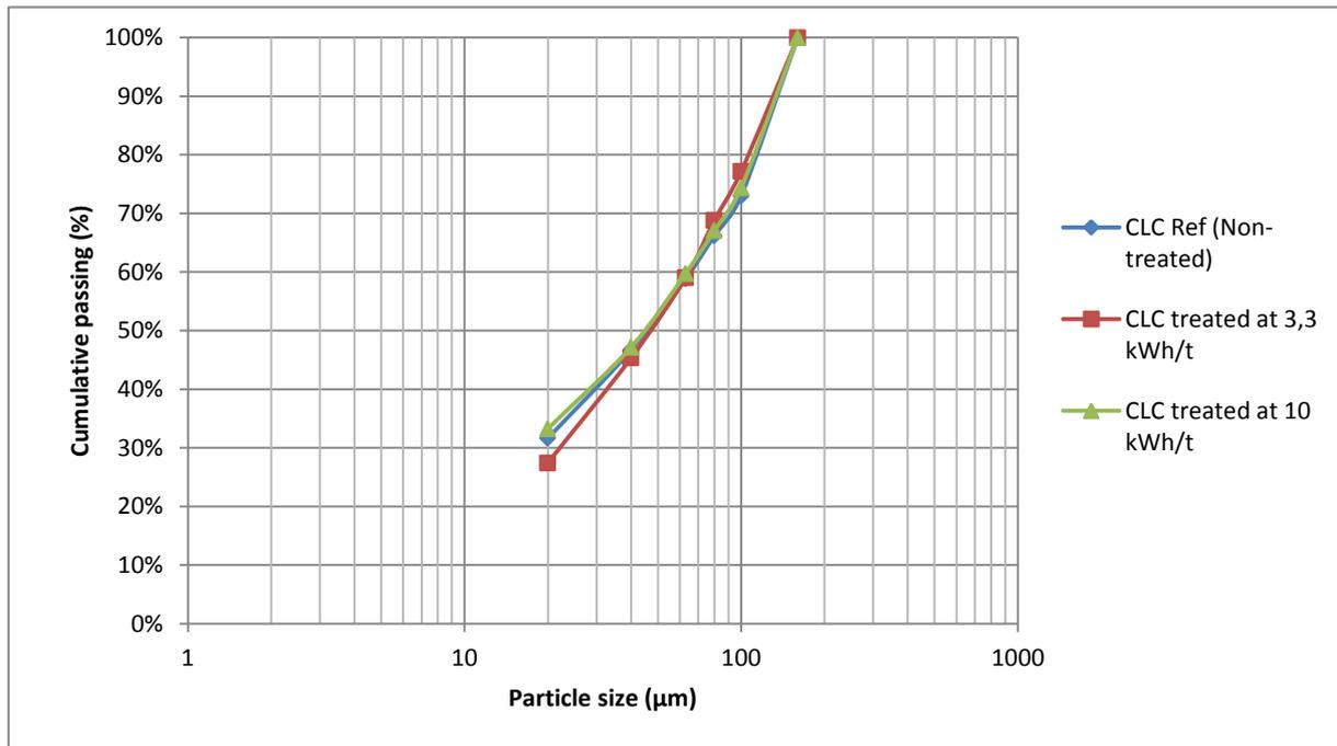
FIGURE 80 - PARTICLE SIZE DISTRIBUTIONS OF GROUND SAMPLES OF CLC MICROWAVE TREATED AND UNTREATED.
