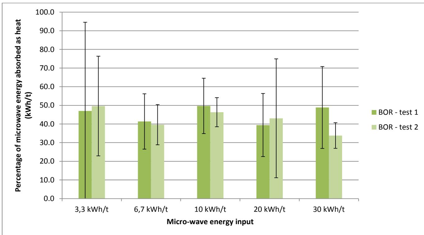
FIGURE 19 - PERCENTAGE OF ENERGY ABSORBED AS HEAT REGARDING THE MICROWAVE TREATMENT OF BOR SAMPLES.
