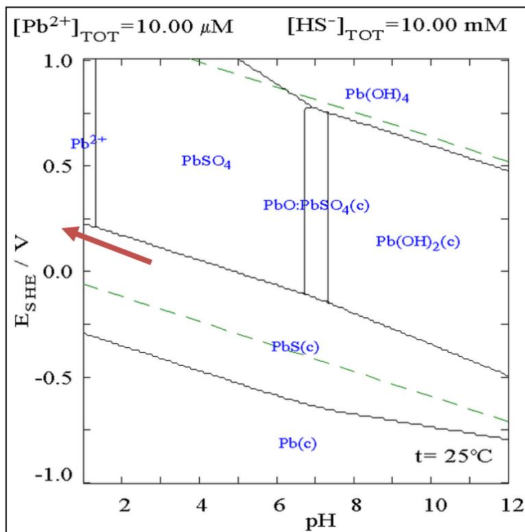
FIGURE 59 - POURBAIX DIAGRAM FOR LEAD IN SULPHATE MEDIA.
