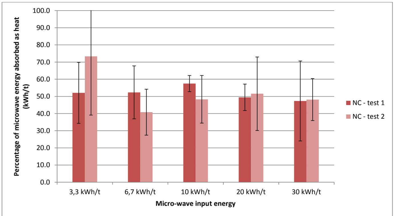
FIGURE 17 - PERCENTAGE OF ENERGY ABSORBED AS HEAT REGARDING THE MICROWAVE TREATMENT OF NC SAMPLES.
