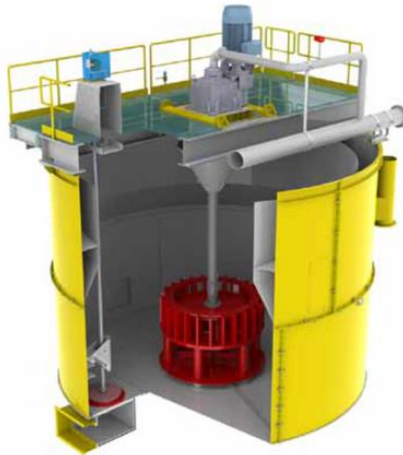
FIGURE 8. OUTOKUMPU TANKCELL DIAGRAM
